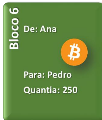
Figura III – Informação armazenada num bloco; (fonte: elaboração própria)
