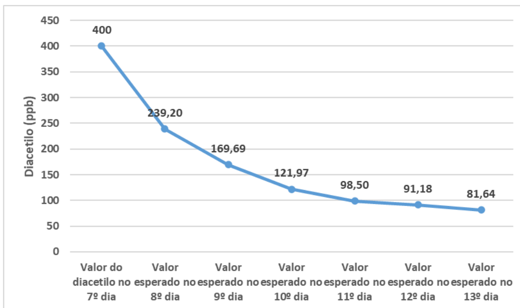
Figura 5.22 - Previsão da curva de diacetilo e dos valores de diacetilo (ppb) esperados entre os 8º e 12º dias, em Sagres Preta, com base na concentração de diacetilo ao 7º dia; exemplo para concentração de 400 ppb ao 7º dia
