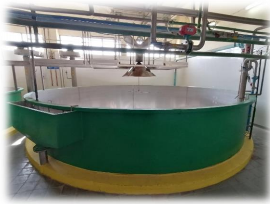
Figura 3.3 - Tina de demolha da cevada
