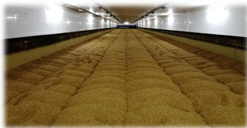
Figura 3.4 - Caixa de germinação do malte
