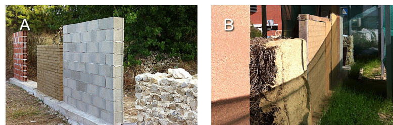
Figura 46 – Estação de Exposição Natural do Departamento de Engenharia Civil da FCT NOVA, Caparica, adaptado de Faria et al. (2014).
