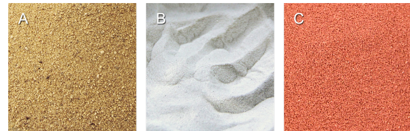
Figura 10 – Agregados utilizados na execução de argamassas. (A) Areia siliciosa natural. (B) Areia calcária artificial. (C) Resíduo cerâmico triturado.
