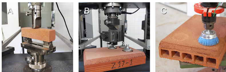
Figura 17 – Ensaios de resistência de argamassas de terra. (A) À tracção por flexão. (B) Ao arrancamento. (C) À abrasão.
