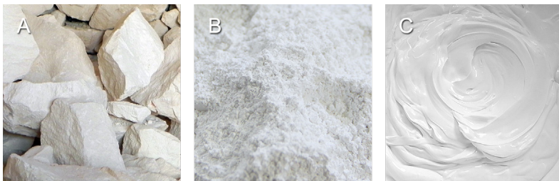
Figura 9 – Cal aérea calcítica. (A) Viva em pedra. (B) Hidratada, em pó. (C) Hidratada em pasta.
