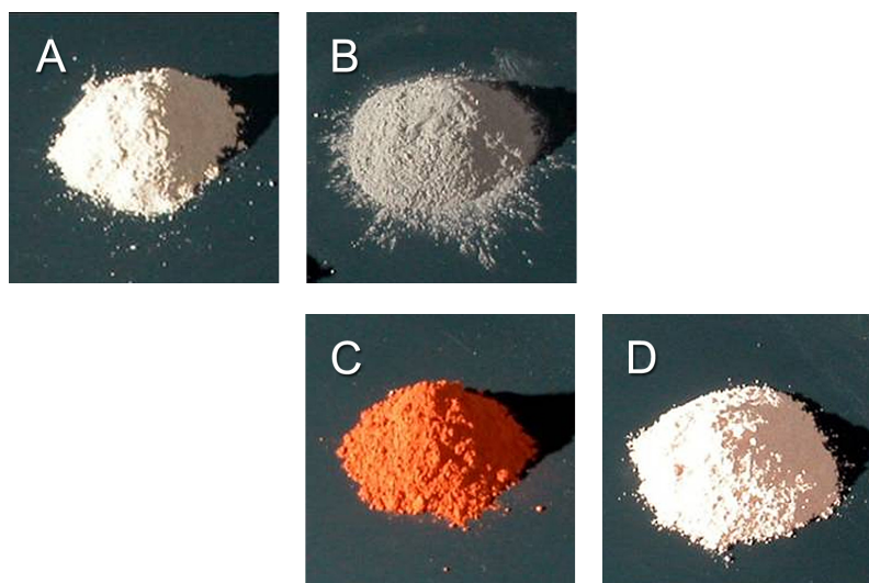
Figura 11 – Pozolanas naturais ou artificiais. (A) Pozolana natural de Santo Antão, Cabo Verde. (B) Cinza volante. (C) Barro vermelho cozido. (D) Caulino cozido (metacaulino).
