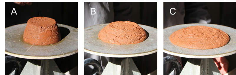
Figura 23 – Avaliação indirecta da trabalhabilidade de uma argamassa de terra no estado fresco através do ensaio de consistência por espalhamento.
