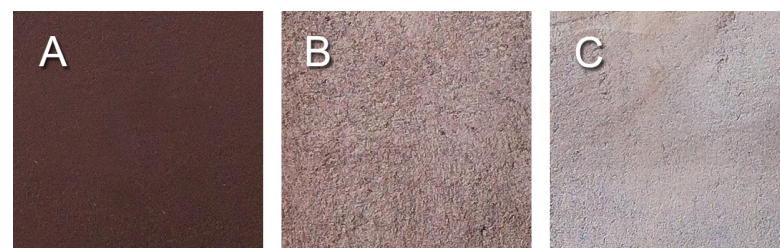
Figura 38 – Painéis de reboco de terra de “cor chocolate”, adaptado de Santos et al. (2017a).
