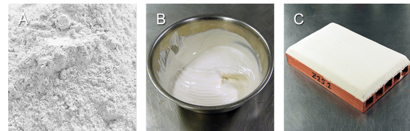
Figura 8 – Gesso correntemente usado na construção. (A) Em pó. (B) Amassado com água. (C) Endurecido após aplicado sobre tijolo.
