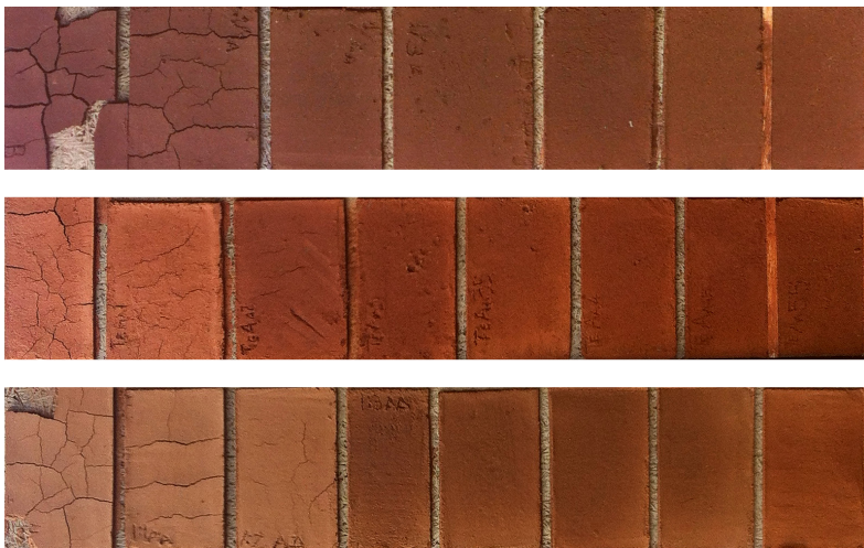
Figura 24 – Amostras de rebocos formulados com terras distintas e teor de areia crescente da esquerda para a direita, apresentando retração diferenciada.
