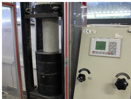
(b) Ensaio de compressão: provete cilíndrico.
