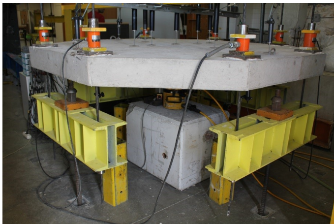
Figura 4.4: Aspecto geral de ensaio dos modelos de laje sujeitos a ações verticais monotónicas.
