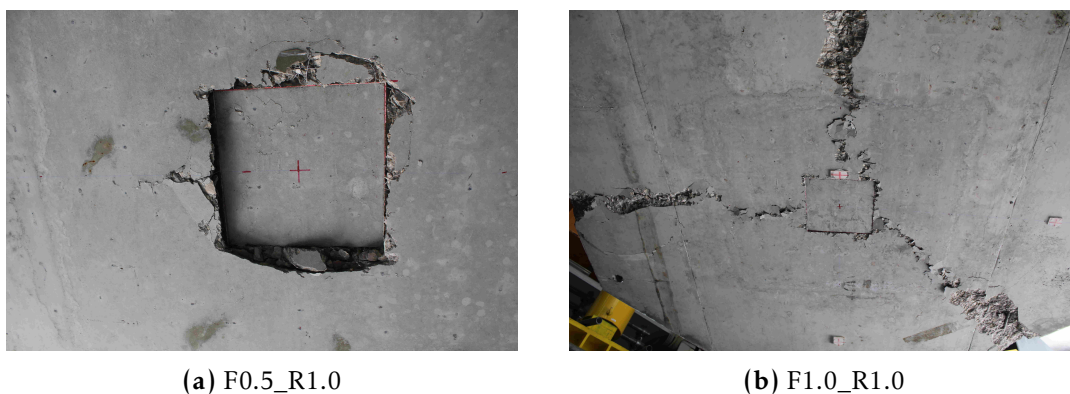
Figura 4.39: Vista inferior dos modelos F0.5_R1.0 e F1.0_R1.0 depois de ensaiados.
