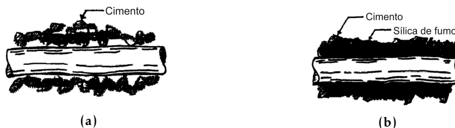
Figura 3.7: Representação esquemática do agrupamento das partículas na interface no caso da fibra embebida: (a) em matriz cimentícia convencional e (b) na matriz cimentícia com adição (adaptado de [105]).
