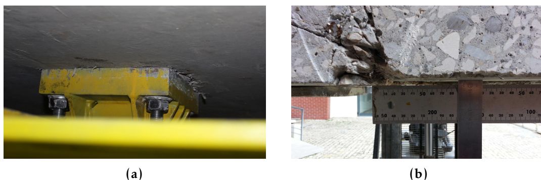
Figura 6.64: Esmagamento no BRFA no perímetro do pilar, na face inferior: (a) antes da rotura dos modelos e (b) no final do ensaio do modelo F1.0_4D.
