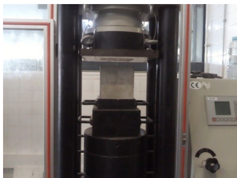
(a) Ensaio de compressão: provete cúbico.
