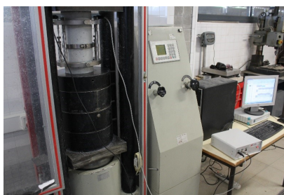
Figura 3.36: Esquema de ensaio utilizado na determinação do módulo de elasticidade.
