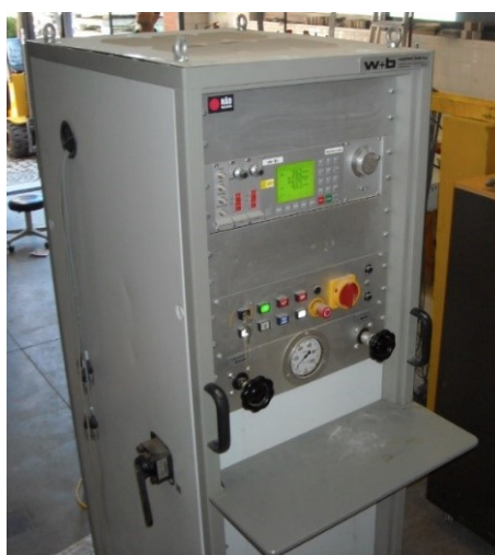
Figura 4.6: Aspecto geral do grupo hidráulico WALTER+BAI AG tipo NSPA 700 / DIG 2000.
