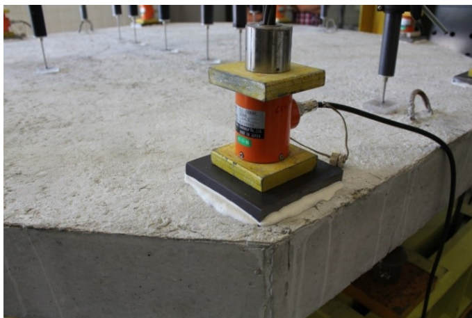
Figura 4.5: Placas de aço colocadas sobre uma camada de gesso.
