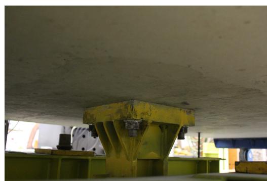
(d) Vista da ligação do pilar à face inferior do modelo de laje F1.0_3D.
