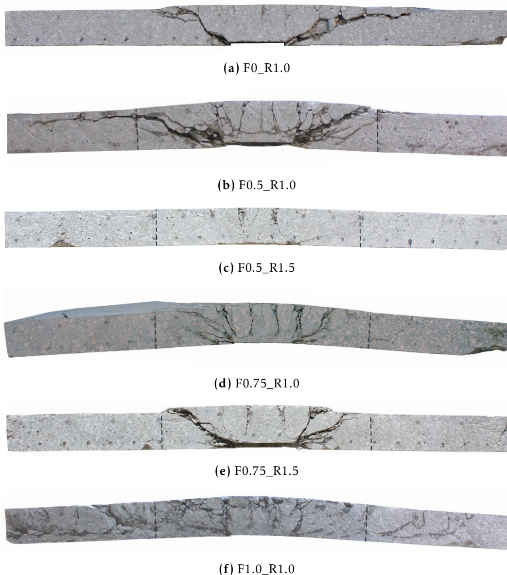
Figura 4.43: Vista da superfície de rotura dos modelos na direção y.
