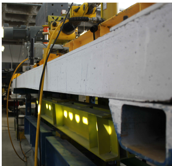
Figura 6.28: Vista lateral do modelo F0.75_4D durante o ensaio para os ciclos de 4% de drift .
