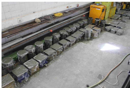
Figura 3.31: Provetes mantidos no laboratório, cobertos por uma película de polietileno.
