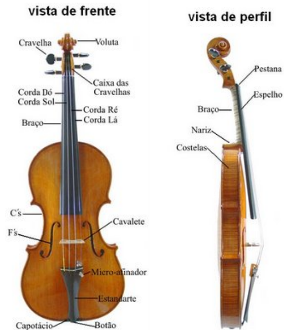
Fig. 5 – Viola de Arco vista de frente e de perfil. Fonte: http://violadarco.blogspot.pt/2010/04/sua-constituicao.html
