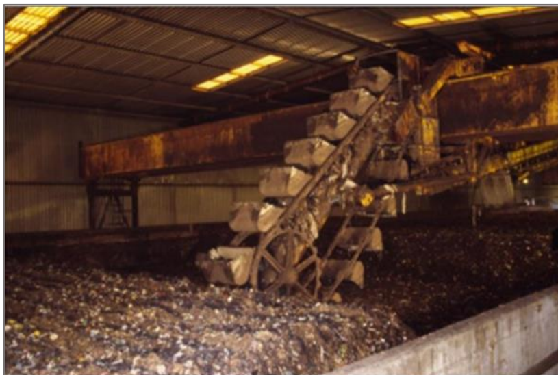
Figura 5.6 - Edifício da Compostagem. Máquina de deposição automática
