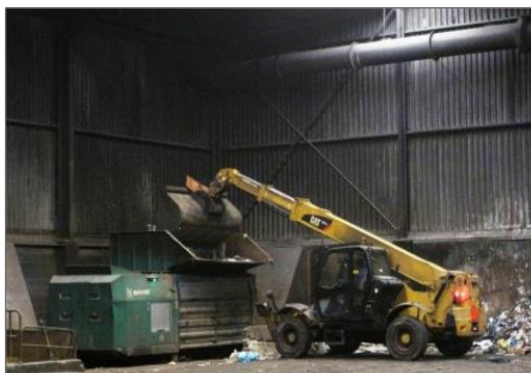
Figura 5.4 - Área de receção e descarga em abre-sacos.
