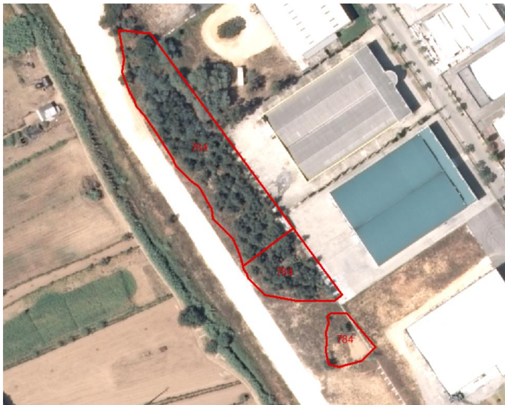
Figura 6 . Exemplo de um polígono obtido através de levantamento de dados no local com GPS
