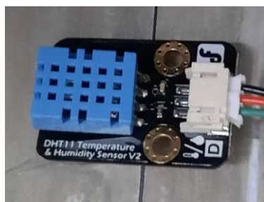
Figura 26 – Sensor DFROBOT – DFR0067 de temperatura e humidade usado na câmara
