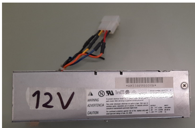
Figura 27 - Fonte de alimentação adaptada ao circuito
