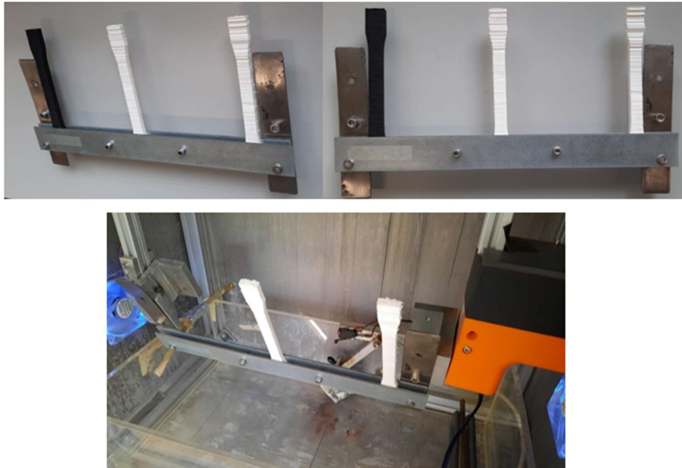
Figura 31 – Diversas vistas do apoio projetado para os provetes
