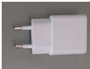
Figura 23 - Transformador usado para fornecer energia à placa controladora
