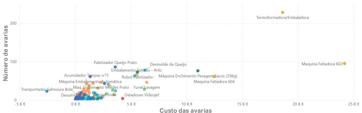
Figura 5.17. Análise do Número de Avarias versus os Custos da Avaria por Equipamento da Queijaria do Ponto de Vista da Manutenção
