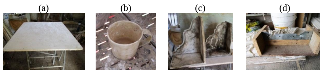
Figura 2. “Estância” ou “tablacho” (a); “polícia” para dosagem da água (b); elementos moldados corridos in situ : moldes na posição de moldar (c); molde na posição de cortar (d).
