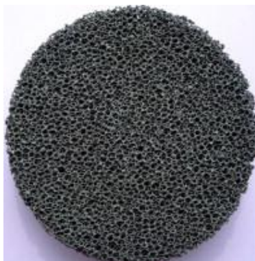
Figura 5 - Geometria de um absorsor em formato de espuma com cavidades expostas (OCF) [40].
