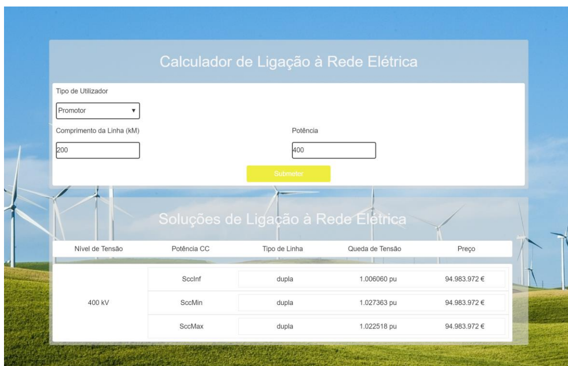
Figura 4.19 - Exemplo de soluções técnico-económicas viáveis, disponibilizadas para um promotor que requer um comprimento de linha de 200 km e uma potência igual a 400 MW
