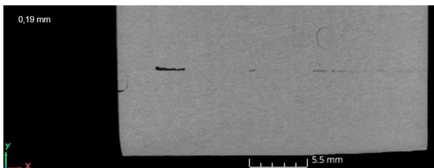
Figura 5.50 - Vista superior da amostra D6 com profundidade de 0,19 mm. Canal produzido com \mu C 0,3 mm, \omega = 12.000 rev/min, V = 25 mm/min. (Link para vídeo ).
