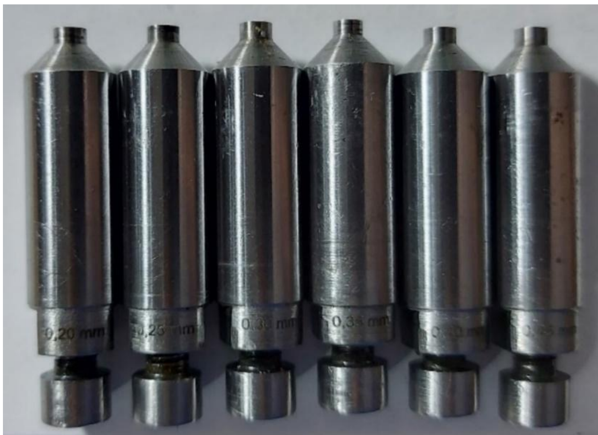
Figura 3.11 - Ferramentas montadas sem os pinos roscados (da esquerda para a direita), com diâmetros nas medidas de 0,20 - 0,25 - 0,30 - 0,35 - 0,40 e 0,45 mm.
