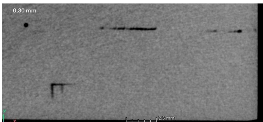
Figura 5.51 - Vista superior da amostra F8 com profundidade de 0,30 mm. Canal produzido com \mu C 0,3 mm, \omega = 12.000 rev/min, V = 25 mm/min. (Link para vídeo ).
