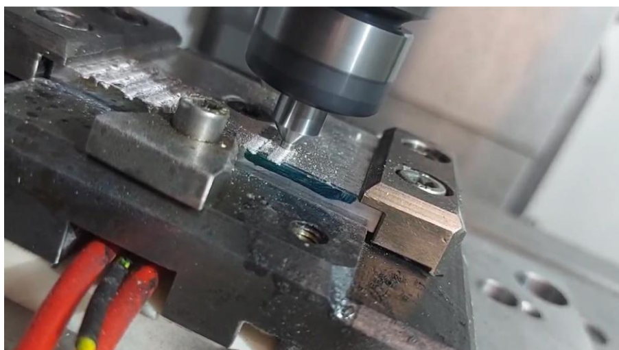
Figura 5.8 — Execução de microcanal com ferramenta de Pino de 0,3 mm.
