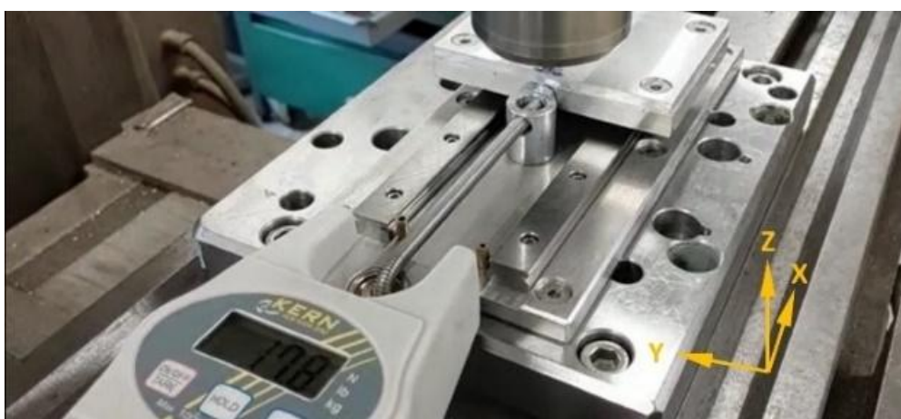
Figura 5.10 Medição de força na direção de avanço da ferramenta.
