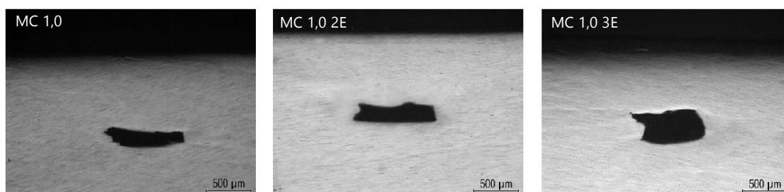
Figura 5.21 - Comparação dos canais produzidos com v = 145 \text{ mm/min} e \omega = 2440 \text{ rev/min} - adaptado de [18].
