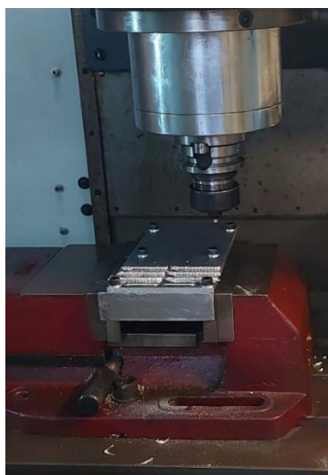
Figura 4.7 — Detalhe da fixação do dispositivo no centro de usinagem com alguns minicanais.
