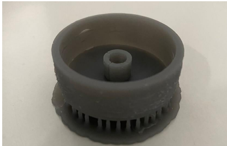
Figura 4.17 - Erro funcional causado pela falta de suportes
