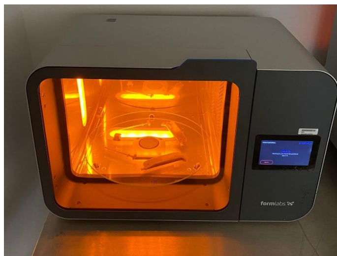
Figura 4.30 - Cura de 5 peças distribuídas radialmente
