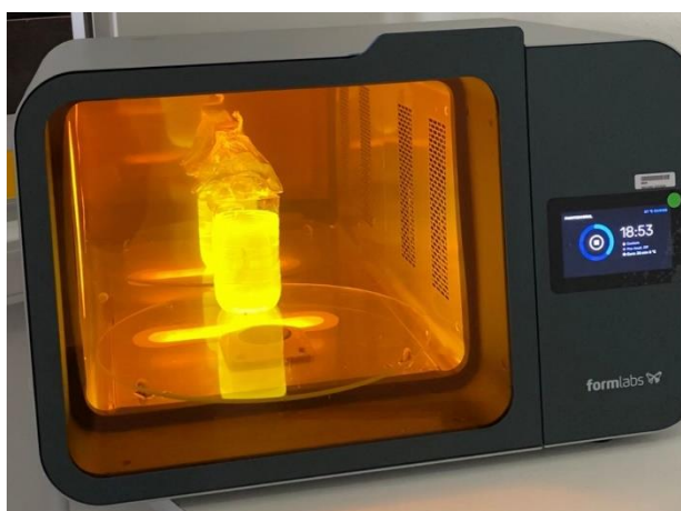
Figura 4.28 - Curadora a emitir luz UV com recipiente
