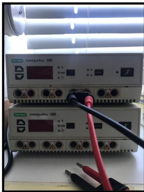
Figura 6. Fonte de alimentação de suporte à tina de eletroforese Bio-Rad PowerPac™ 300 (Fotografia do Autor)
