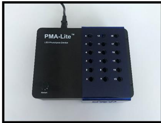
Figura 9. Equipamento utilizado para o teste de viabilidade de leptospiros- PMA-Lite™ LED Photolysis Device (Fotografia do Autor)
