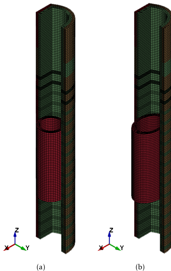
Figura 3.17: Vista da localização dos implantes de secção circular e elíptica a 70 mm da extremidade inferior do modelo
