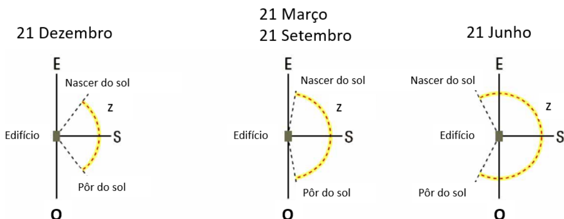
Figura 2.5 - Amplitude de Azimute desde o nascer do sol até ao pôr do mesmo (Adaptado de [21])
