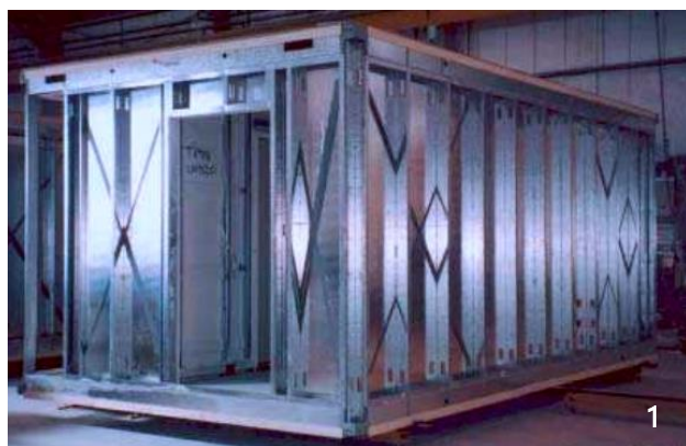
1 - Módulo continuamente apoiado em aço leve; 2 - Módulo de suporte de canto
