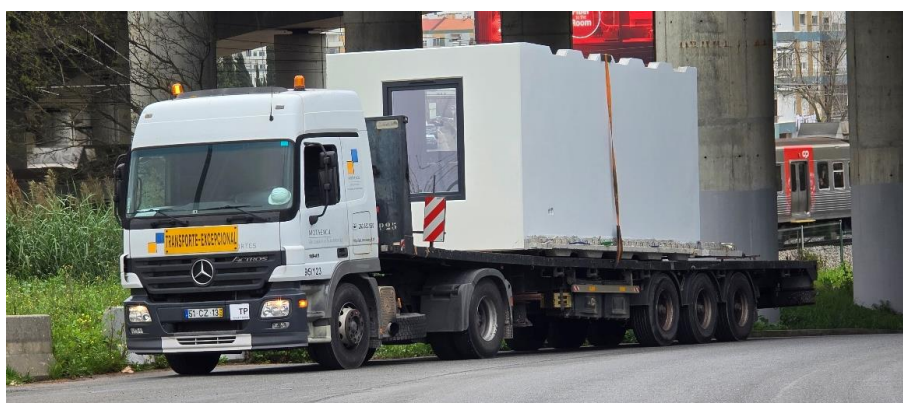
Figura 2.10 — Transporte de um Módulo 3D em betão
