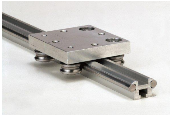
Figura 4.4 – Sistema de guiamento por caminhos de rolamento. Retirado de [11].
