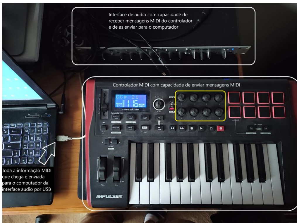
Figura 2.2: Montagem básica de um controlador MIDI por USB
