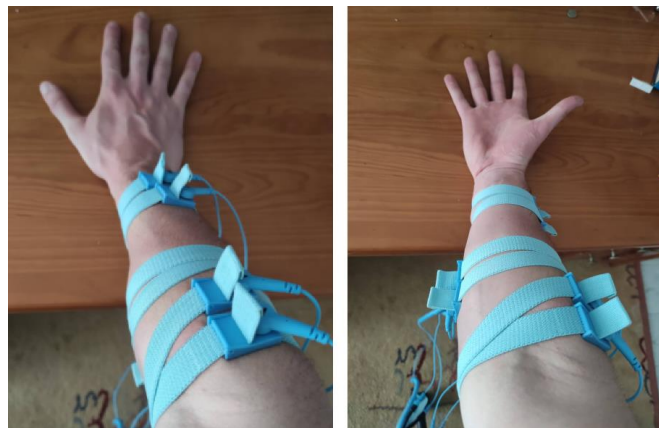
Figura 4.5: Posição dos sensores no braço direito de forma a capturar actividade de três músculos distintos do braço (adaptado de [56])
