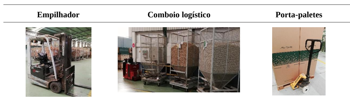
Figura 3.4 - Equipamentos de movimentação e de transporte utilizados na Equipar (não inclui tubagens nem tapetes)
