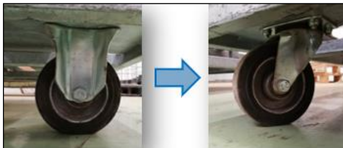
Figura 4.12 - Roda com apoio fixo (esquerda) e roda louca (direita)
