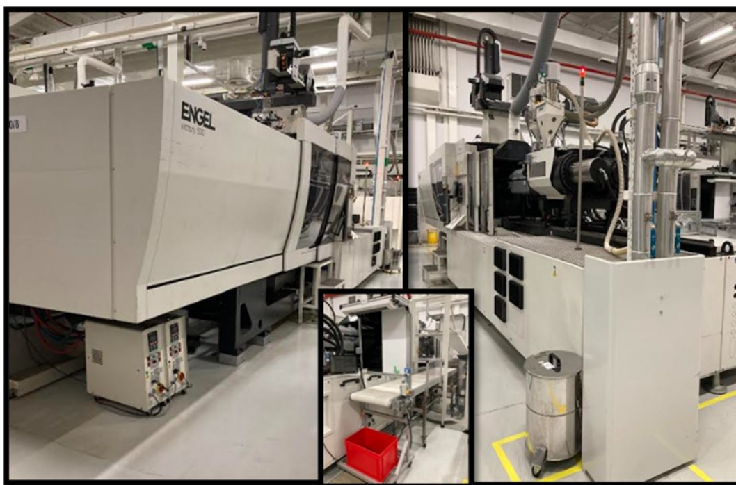
Figura B.8- Máquina de moldagem por injeção Engel Victory 3550/500 tech , de 500 toneladas de força de fecho, utilizada para as produções das peças Mask com o material Novodur HH-112 .
