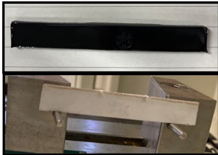
Figura B.17- Provetes em formato de bastonete para os ensaios de impacto, em cima de Novodur HH-112 e em baixo de Novodur HH-10, com as dimensões de 7,5 cm de comprimento, 1,0 cm de largura e 0,5 cm de espessura.
