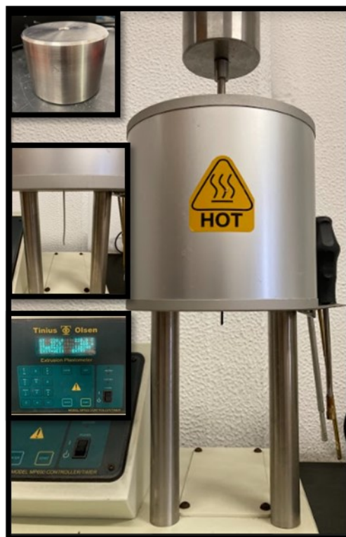
Figura B 24- Medição do índice de fluidez (MFI) realizada com o granulado virgem e reciclado para as matérias-primas Novodur HH-112 e Novodur HH-106, utilizando o equipamento TINIUS OLSEN pertencente ao laboratório de polímeros do DCM.
