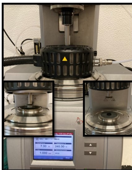
Figura B 25- Reômetro Rotacional Gemini HRnano , pertencente ao laboratório de polímeros do DCM, utilizado com geometria de pratos paralelos (P/P) para os ensaios em modo dinâmico e estacionário dos discos de Novodur HH-112 e de Novodur HH-106.
