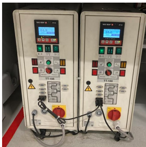
Figura B.7 - Termorreguladores responsáveis pela circulação de águas no molde, um para a metade do molde do lado da cavidade e outro para a metade do molde do lado da bucha.
