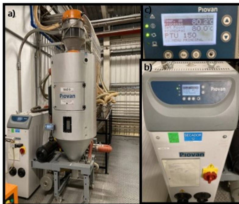
Figura B.3 - Equipamento de secagem das matérias-primas, (a) com silo Piovan, (b) secador de secagem Piovan utilizados e (c) com referência à temperatura de secagem de 80°C programada no display do secador.
