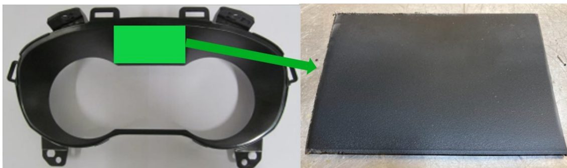
Figura B.12 - Exemplo de Mask produzida com Novodur HH-112, com identificação da secção de material retirada da zona verde da peça, a partir da qual foram feitos os provetes necessários para os ensaios mecânicos e reológicos.
