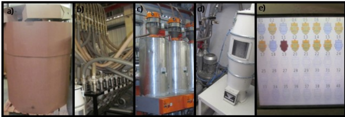
Figura B.4 - Representação do procedimento de alimentação das matérias-primas Novodur HH-112 e Novodur HH-106: com (a) octobine com lote de matéria-prima, (b) mesa de distribuição da matéria-prima, (c) unidades de controlo de aspiração (UCA), (d) unidade de vácuo e (e) unidade de comando (QC).
