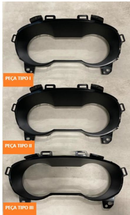
Figura B.10- Peças Mask Tipo I, II e III amostra, produzidas respetivamente com as três proporções de matéria virgem e reciclado de Novodur HH-112.
