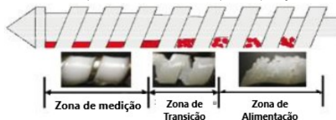
Figura 2-3- Progressão do estado do material ao longo das três zonas do interior do cilindro de plastificação [8].
