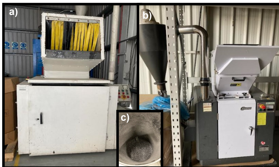
Figura B.1- Reciclagem das peças não conformes por moagem mecânica, através de uma trituração primária (a) por um moinho mecânico MRU 45.65 IV e de uma redução secundária (b) através de um granulador SG-2336-CE, obtendo-se (c) o material reciclado granulado.
