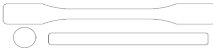
Figura B.14- Configuração do desenho dos diferentes provetes fabricados do Novodur HH-112 e Novodur HH-106, desenhados.
