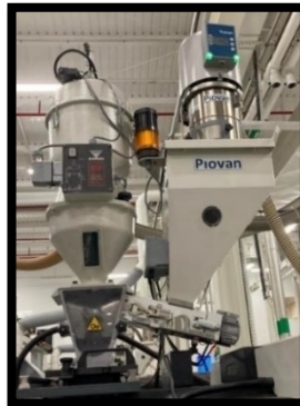
Figura B.5 - Tremonha PIOVAN S50 equipada com um doseador gravimétrico PIOVAN MDP2.
