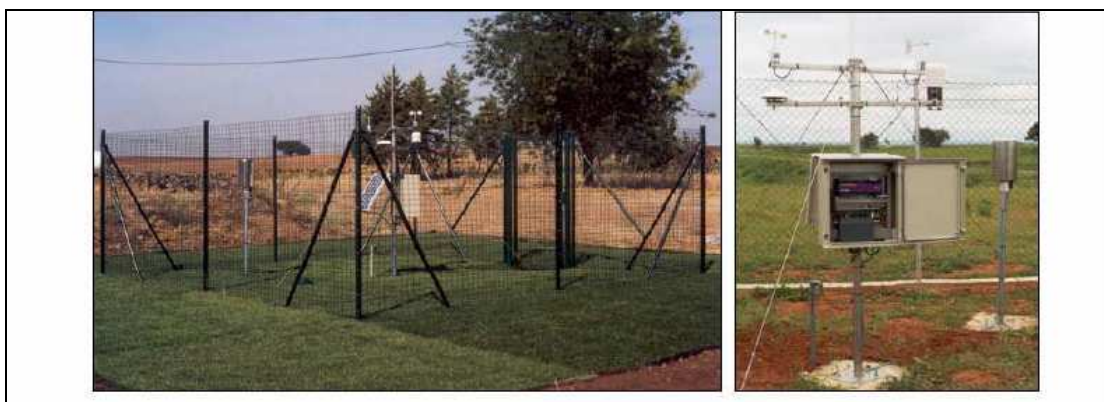
Figura 21 - Aspecto Geral da Estação Meteorológica Automática, cuja Transmissão se faz por GSM
