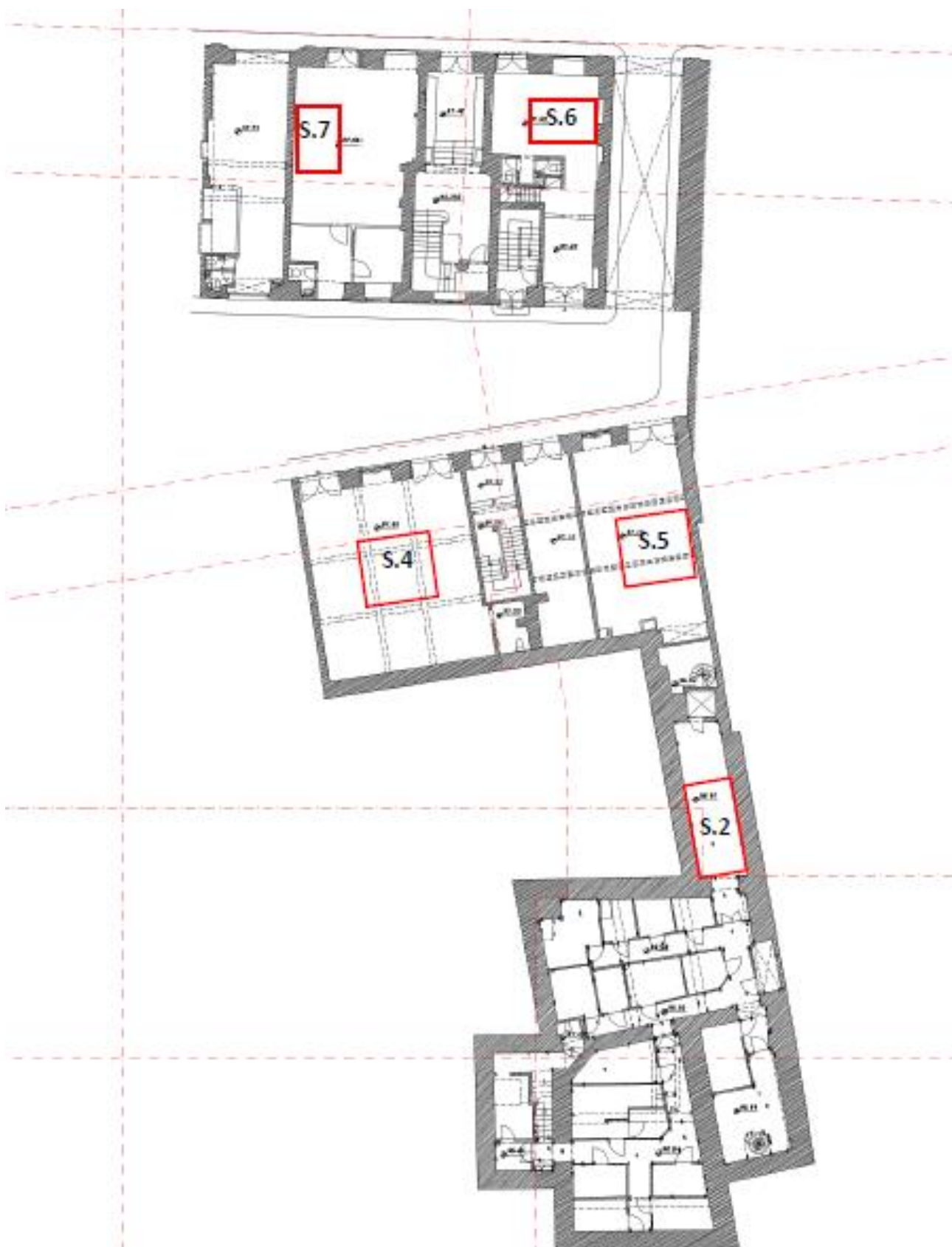
Fig. 47 - Implantação aproximada das sondagens de diagnóstico ao nível do piso -1 – Avenida da Liberdade, n.º12, Pátio do Tronco, n.º 2-2D e Rua das Portas de Santo Antão, ns.º 137-147 (Fonte: Relatório preliminar de trabalhos arqueológicos, Neoépica)
