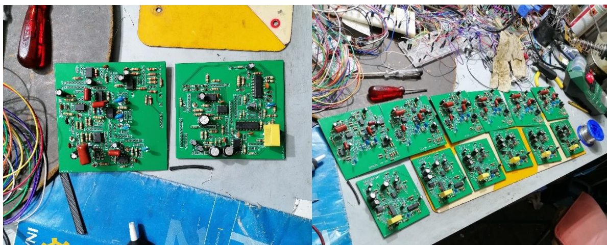
Figura 4.15 - PCBs dos 6 canais.
