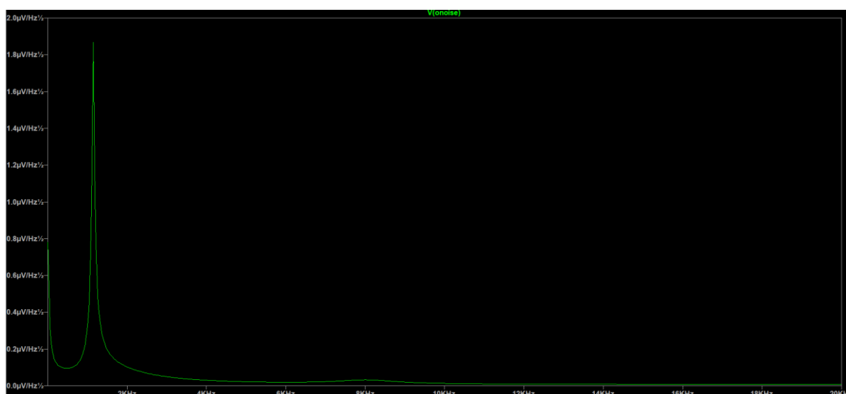
Figura 3.42 - Noise floor do equalizador com todas as bandas e filtros ativos (LTspice).
