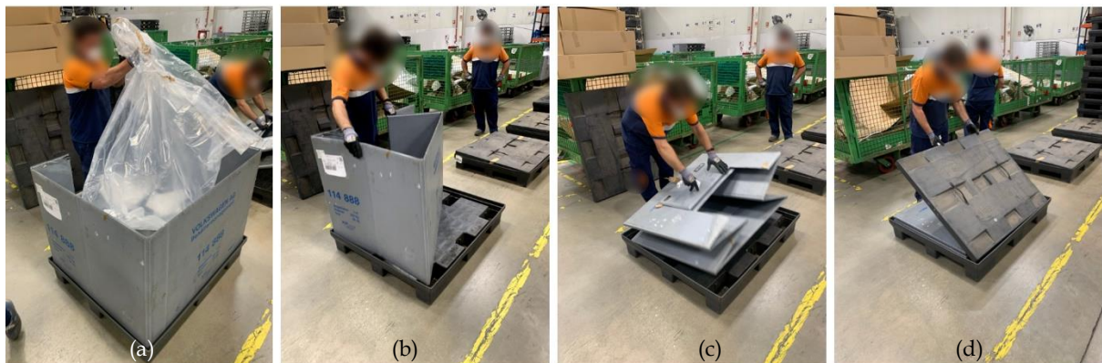
Figura 3.22 - Limpeza na linha das GLTs e Ferro (a) Retirar conteúdo e etiquetas, (b) Dobrar a manga, (c) Colocar manga dentro da embalagem, (d) Colocar a tampa
