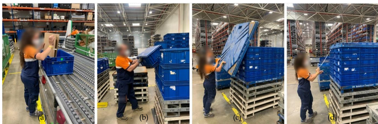
Figura 3.21 - Limpeza na linha das KLTs, (a) Retirar conteúdo e etiquetas, (b) Agrupar KLTs, (c) Criar a GT, (d) Cintar GT
