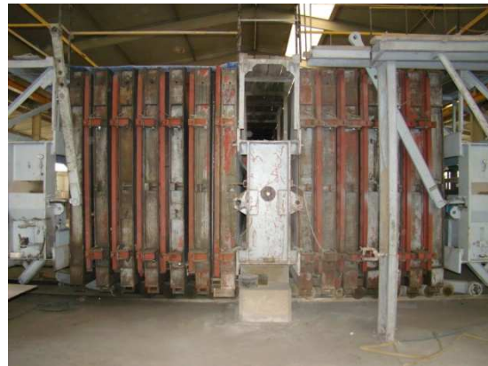
Figura 2.10 – Molde para execução de painéis pré-fabricados na empresa Luso Alemã
