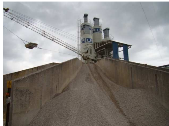
Figura 2.3 - Área de armazenamento dos constituintes do betão para posterior recolha e mistura da fábrica da Luso Alemã
