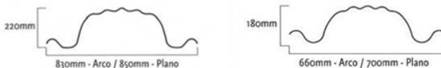
Figura 6.5 – Perfis ómega comercializados pela empresa BLOCOTELHA (adaptada de [42])
