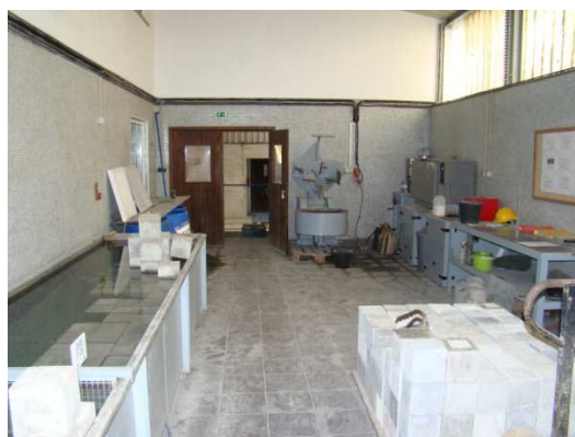
Figura 2.6 – Laboratório para realização de ensaios em amostras de betão da fábrica da Luso Alemã
