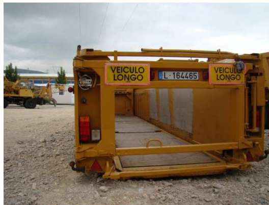
Figura 2.12 – Transporte especial para painéis pré-fabricados com alturas significativas
