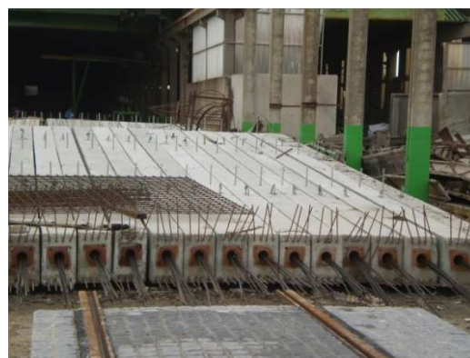
Figura 4.7 – Vigas de cobertura pré-esforçadas com altura variável
