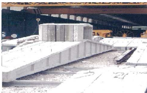
Figura 4.6 – Viga de cobertura com lanternim (extraída de [41])
