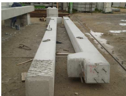
Figura 4.4 – Pilares de seção retangular
