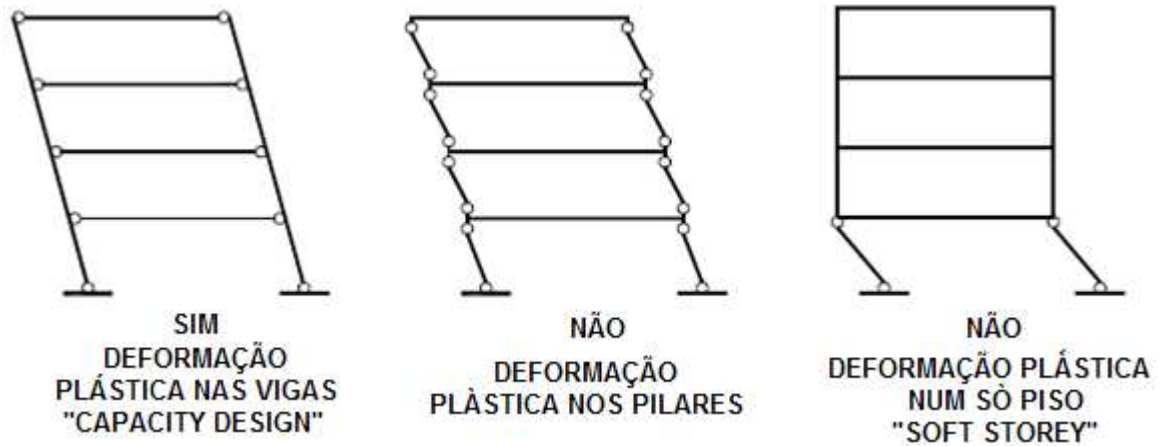
Figura 7.3 – “Capacity design” (extraída de [29])
