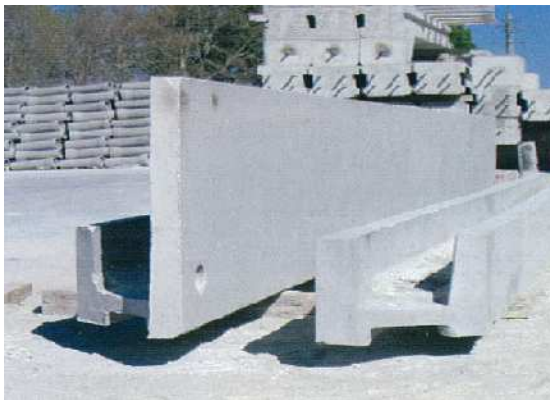
Figura 4.11 – Vigas caleira com platibanda (extraída de [44])
