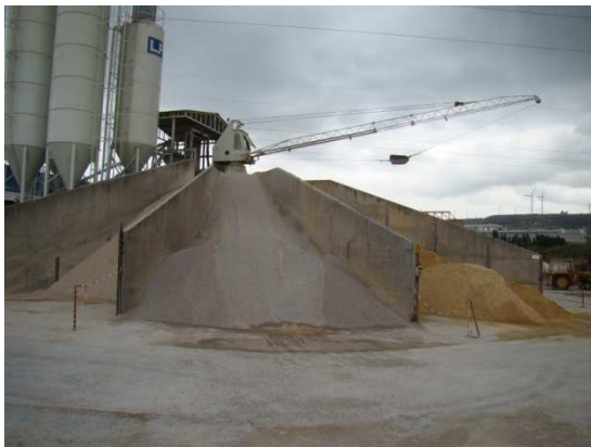
Figura 2.3 - Área de armazenamento dos constituintes do betão para posterior recolha e mistura da fábrica da Luso Alemã
