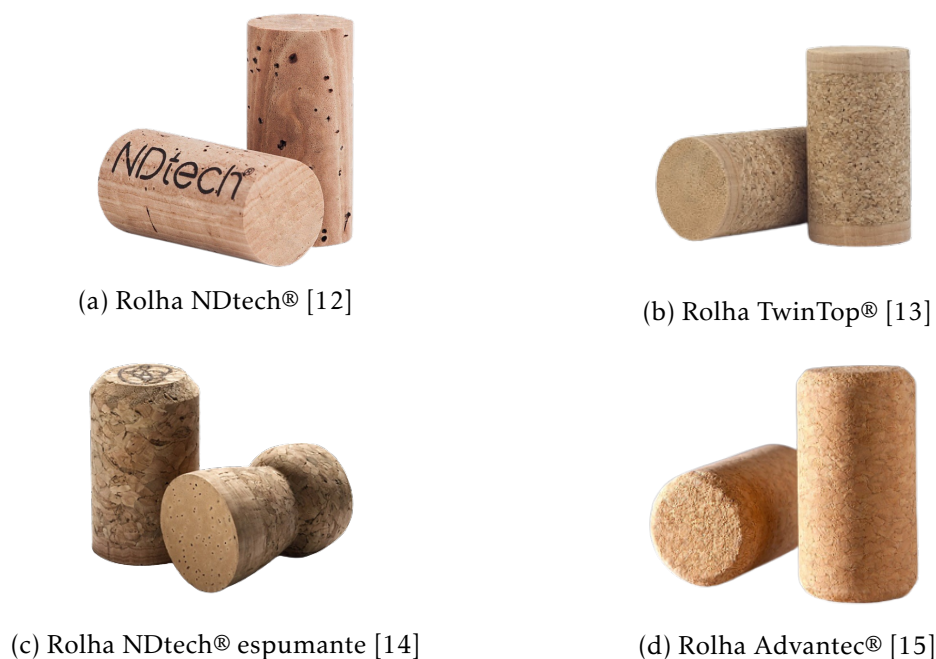
Figura 1.2: Exemplos de rolhas naturais (a), de aglomerado com dois discos (b), de espumante com um ou dois discos (c) e de aglomerado (d). As primeiras são fabricadas a partir de tratamentos mecânicos da cortiça. Todas as outras são fabricadas a partir da colagem e moldação de discos e grânulos de cortiça com colas poliméricas.
