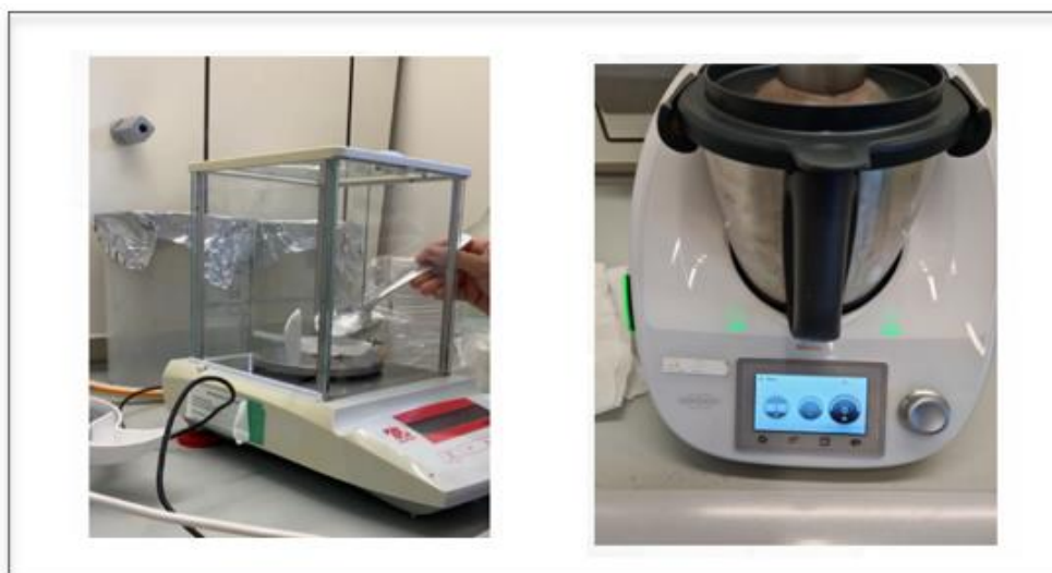
Figura 4.6 – Pesagem em Balança de precisão da marca OHAUS, modelo PX124BR e homogeneização na BIMBY VORWERK 500W.
