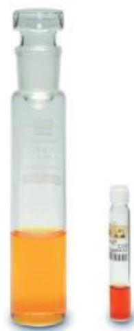
Figura 5.19 – Comparação entre método clássico e kits - redução até 90% dos reagentes necessários [74,83]
