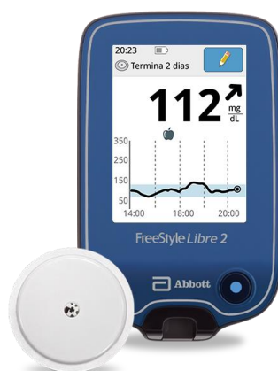
Figura 15: Sensor e recetor do sistema Freestyle Libre 2.
