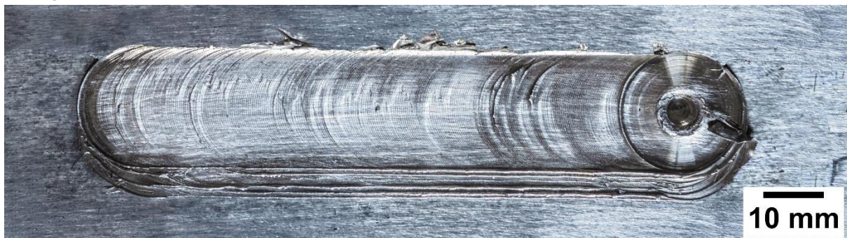
Figura 4.17. UFSP de AZ31B com refrigeração.
