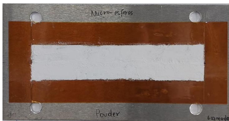
Figura 3.9. Distribuição das partículas na chapa de magnésio inferior.
