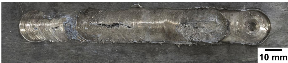
Figura 4.13. UFSP de AZ31B com HA com 0,4 mm de espaçador.
