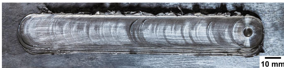
Figura 4.14. UFSP de AZ31B sem refrigeração.
