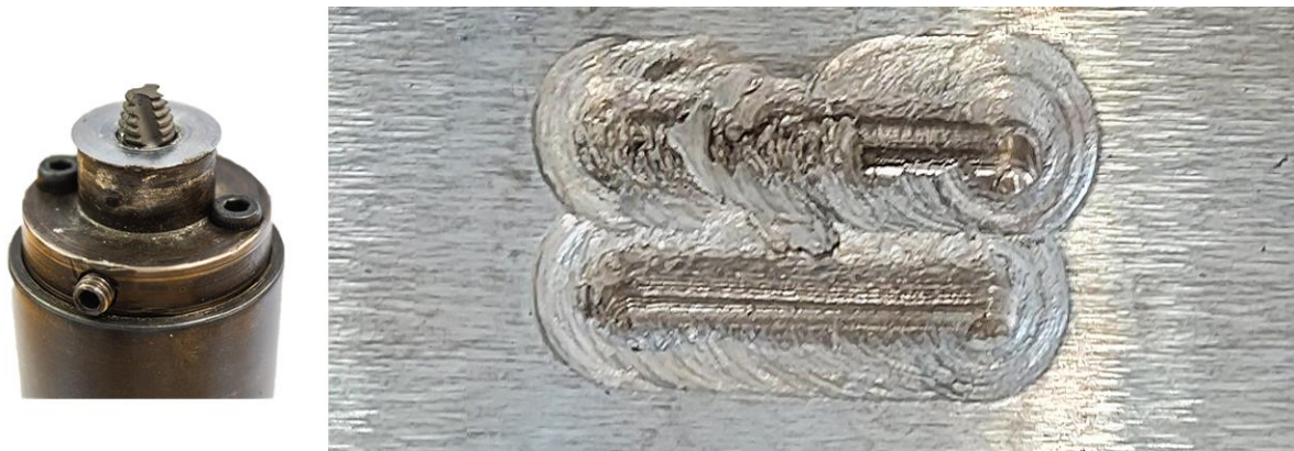
Figura 4.9. UFSP da liga AZ31B com pino de geometria triflute .
