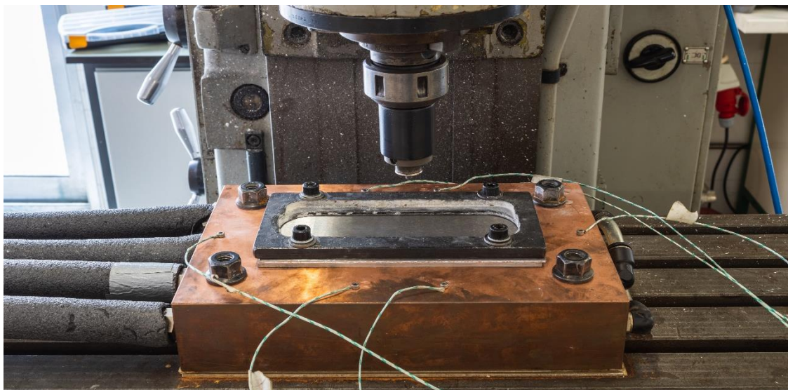
Figura 3.8. Sistema de fixação.
