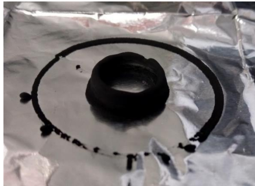
Figura 4.3 – Resultado da impressão com CA
