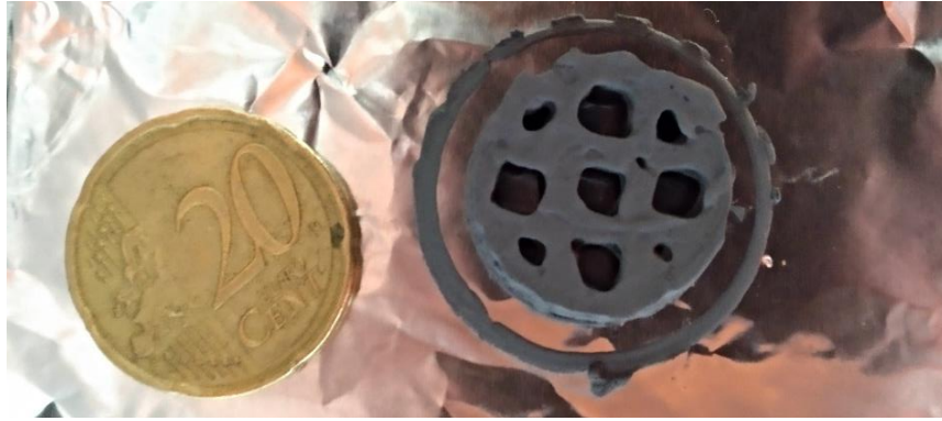
Figura 4.10 – Resultado do ensaio de impressão 19, usando a pasta Zeo-G.
