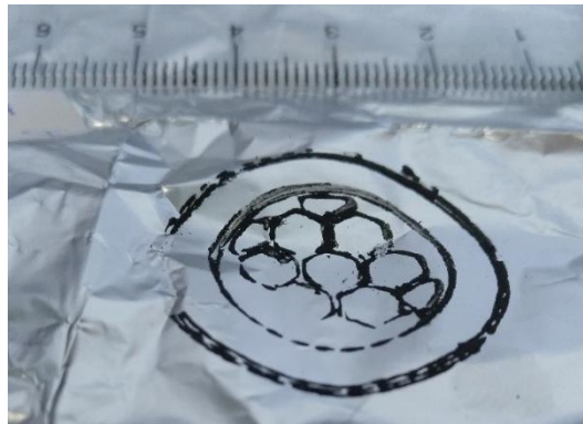
Figura 4.7 – Resultado do ensaio de impressão do monólito honeycomb com canais hexagonais usando a pasta Zeo CA
