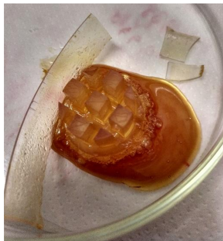
Figura A. 3 - Molde com parede quebrada durante o processo de cura do Resole.
