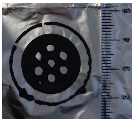
Figura 4.6 - Monólito de canal de dimensão variável (pasta CA).
