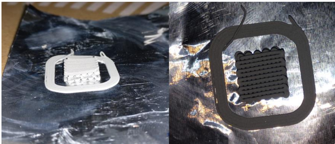
Figura 4.11 – Resultado do ensaio de impressão 21, com Zeo-G.
