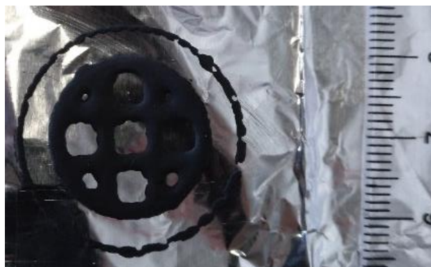
Figura 4.5 – Resultado do ensaio de impressão 4 (com a pasta CA).
