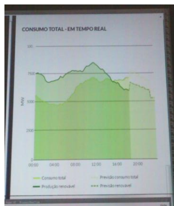
Figura 5-2 Gráficos diário do consumo total (verde claro) e da produção renovável (verde escuro) fotografado diretamente do despacho da REN num dia fortemente exportador
