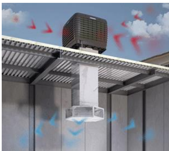
Figura 4.37 Esquema do funcionamento de um sistema de climatização por arrefecimento evaporativo
