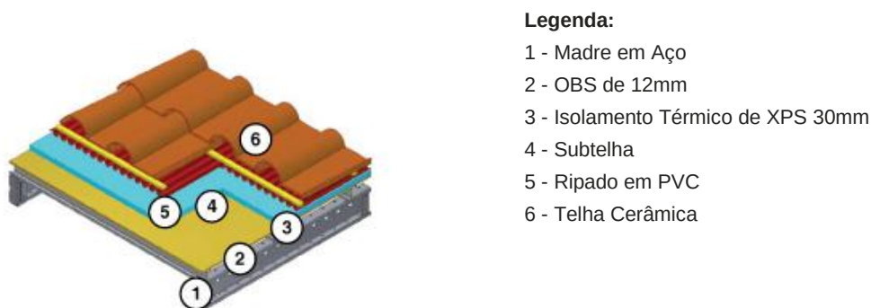
Figura 3.7 - Solução de cobertura inclinada com telha cerâmica [48]
