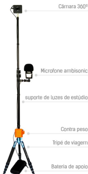
Figura 21 – Configuração criada para as filmagens 360°
