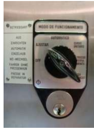
Figura 3.33 – Comutador da prensa 1 em "Manual" Figura 3.34 – Comutador das prensas 2 a 6 em "Ajustar"
