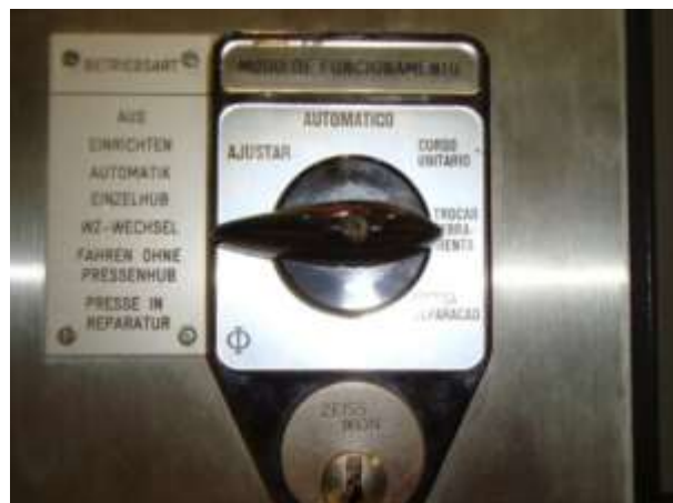
Figura 3.31 – Comutador da prensa em "Trocar ferramenta"
