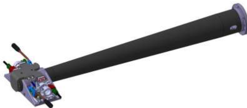
Figura 6.27 – Braço de carbono cónico com peças de acoplamento encaixadas
