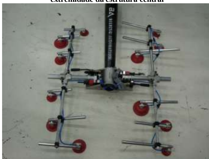
Figura 6.29 – Conjunto braço de carbono cónico e ramos das aranhas (aspecto das futuras automações)
