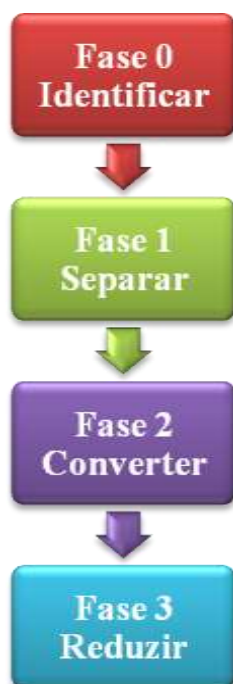
Figura 2.11 – As quatro fases do método SMED (Adaptado: Assis, 1999, p. 6)
