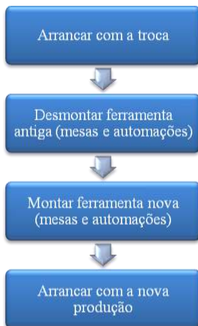
Figura 3.28 – Principais sub-processos do processo de troca de ferramenta
