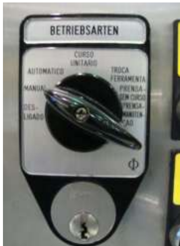
Figura 3.33 – Comutador da prensa 1 em "Manual" Figura 3.34 – Comutador das prensas 2 a 6 em "Ajustar"
