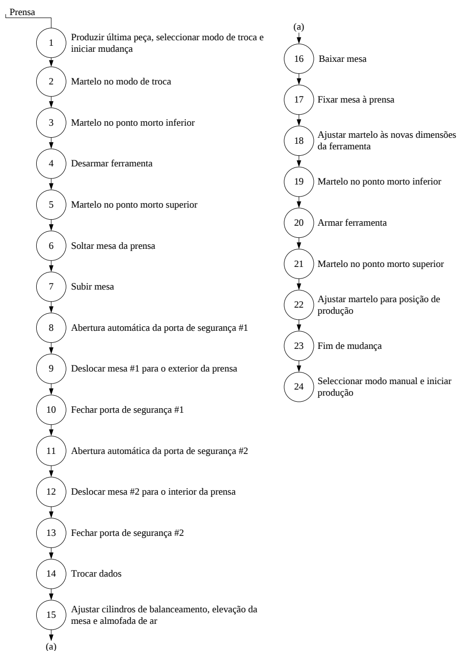
Figura 3.23 – Diagrama de processo para troca de ferramenta nas prensas
