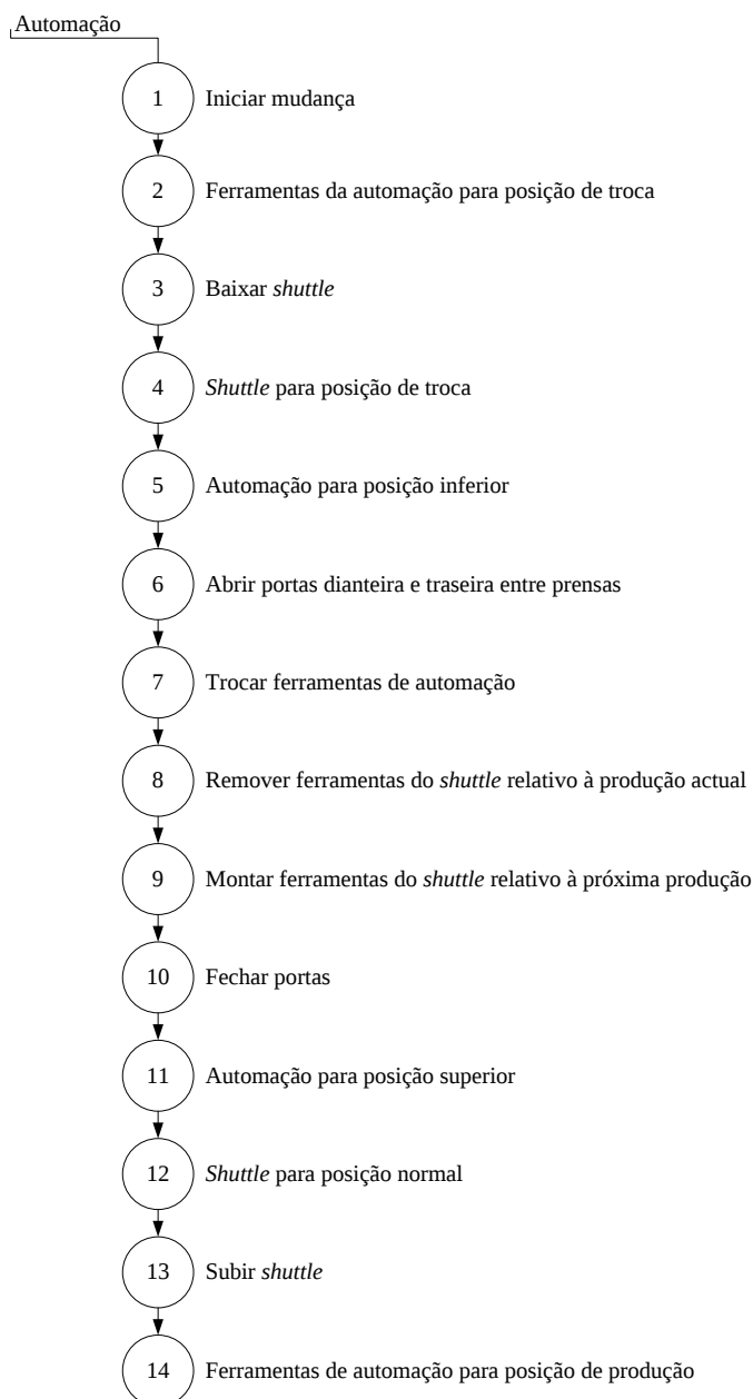
Figura 3.24 – Diagrama de processo para troca de automações
