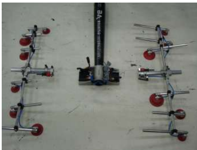
Figura 6.28 – Braço de carbono cónico e ramos das aranhas com peça de acoplamento na extremidade da estrutura central
