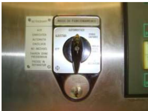
Figura 3.39 – Comutador da prensa em automático
