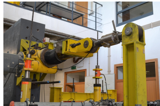
(d) Mechanical actuator and load cell
