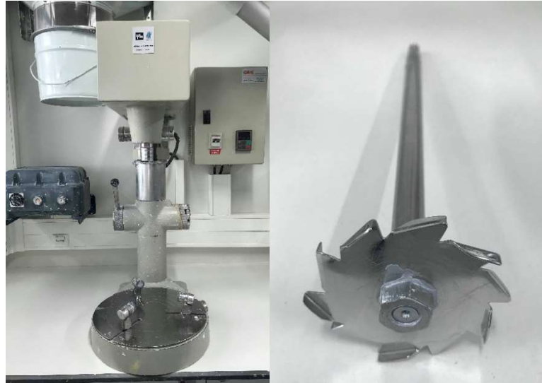
Figura 4.2- Dispersor e lâmina para moagem de oigmentos e cargas.
