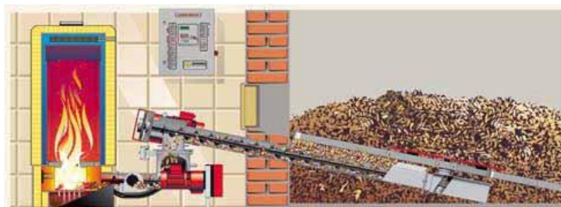
Figura 3.4 - Secção de uma caldeira alimentada por estilhas em que é apresentado o seu transporte até à câmara (Fonte: Greenpro, 2004)
