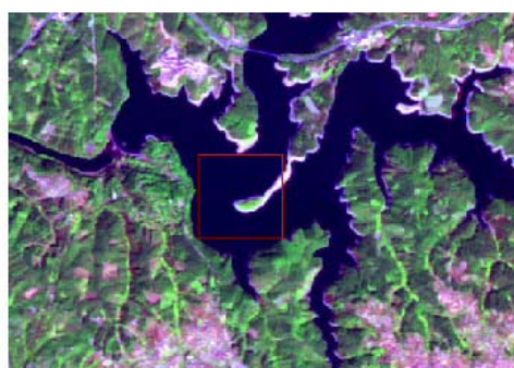
F - Superfícies de Água Interna (com presença de sedimentos)
