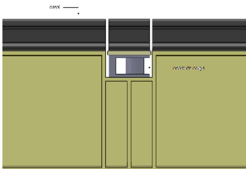
Figura 9.4 – Posicionamento da unidade de pesagem na longarina
