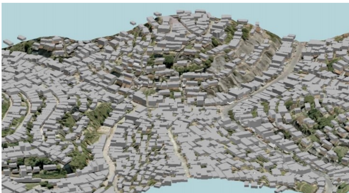
Figura 16. Modelo urbano em 3D com posicionamento do edificado urbano em extensão em área e densidade em volume. Adaptado de Júnio & Silva, (2014).
