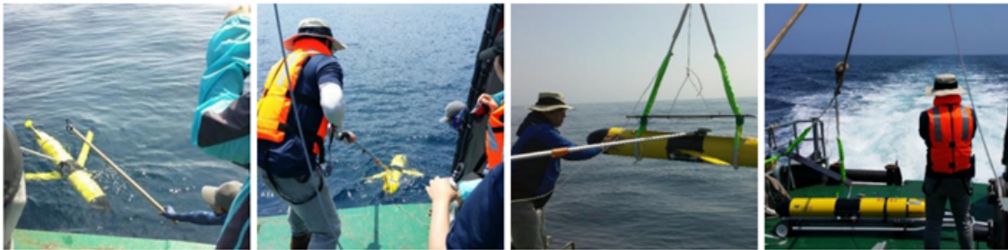
Figura 2.3: Abordagens para recolha manual de gliders subaquáticos. Extraído de [7].
