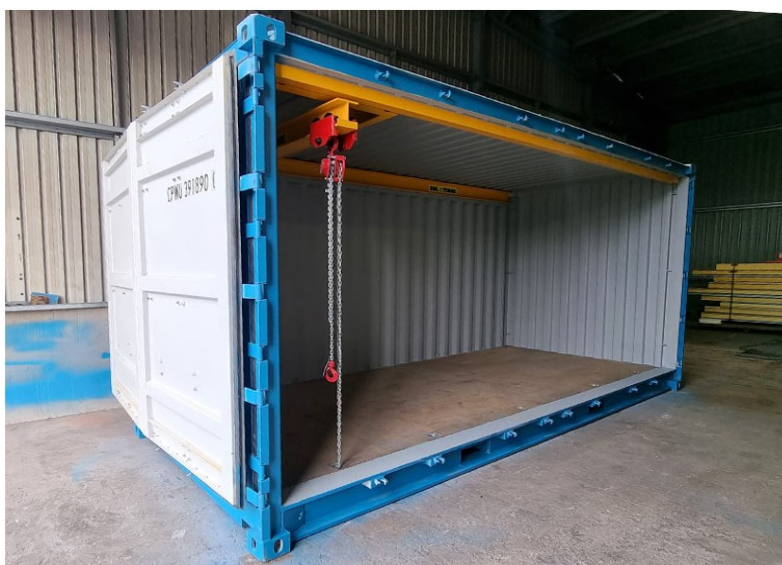
Figura 3.2: Exemplo de grua, do tipo "Ponte Rolante" instalada num contentor disponível no mercado. Extraído de [2].
