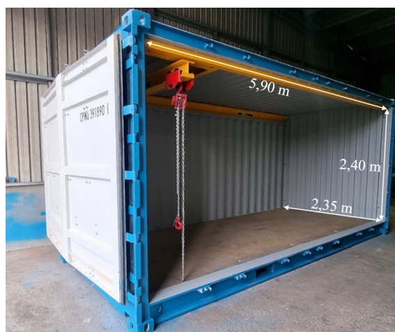
Figura 1.1: Dimensões internas de um contentor de 20 pés. Adaptado de [2].
