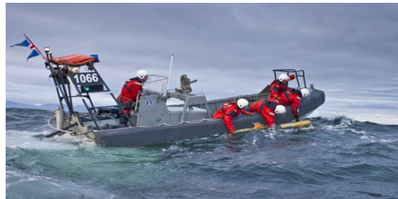
Figura 6.30: Reposição do gancho no glider através de um bote de apoio [27].
