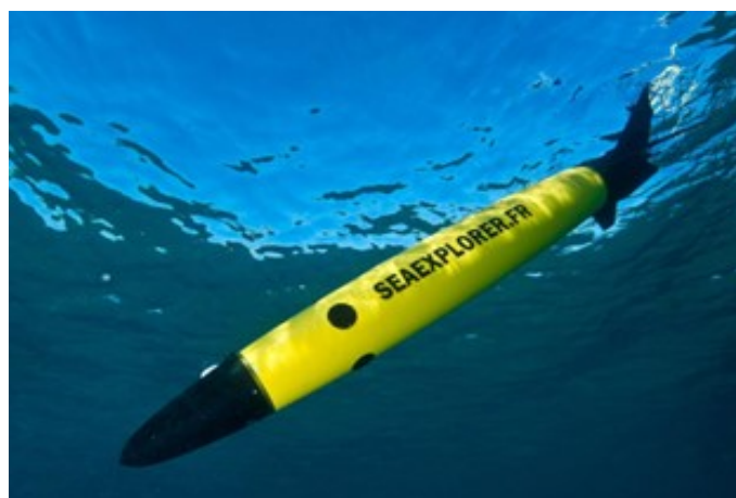
Figura 2.2: Imagem do glider em estudo - SEAEXPLORER ALSEAMAR. Extraído de [5].
