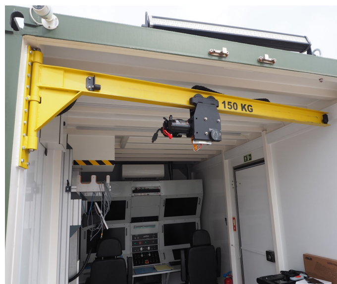
Figura 3.3: Exemplo de uma grua de bandeira com guincho.
