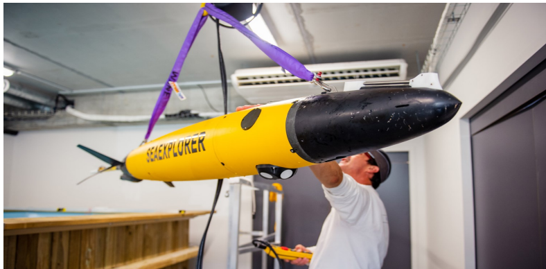
Figura 6.9: Configuração utilizada para fixar o glider ao guincho [23].
