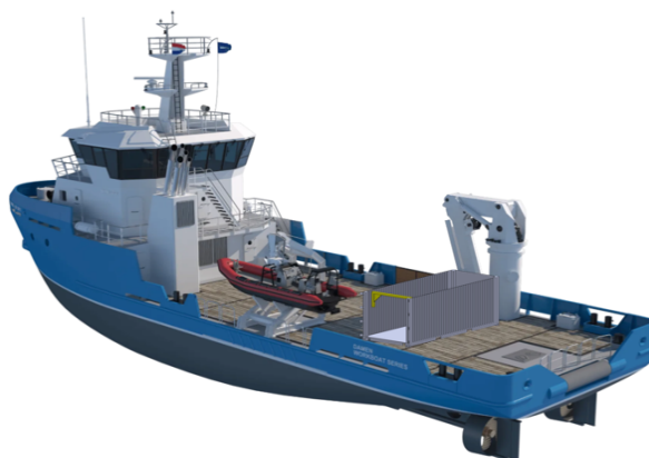
Figura 6.26: Disposição do contentor no navio com a rotação de 90 graus.
