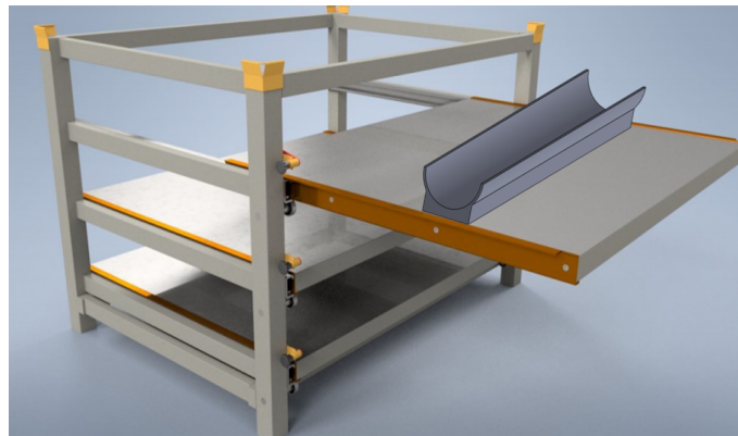
Figura 6.15: Estrutura com prateleiras retráteis utilizando calhas deslizantes.
