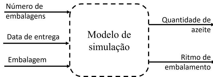
Figura 3.5: Esquema da simulação de encomendas.
