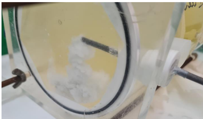
Figura 21 - Precipitado formado no compartimento do ânodo (ensaio A3.48).
