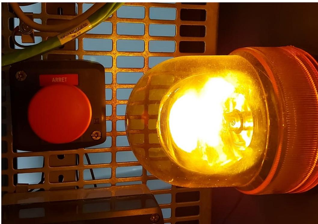
Figura 4.3: Foto do Sinal Luminoso ativo no momento em que se encontra aberta a válvula de enchimento.
