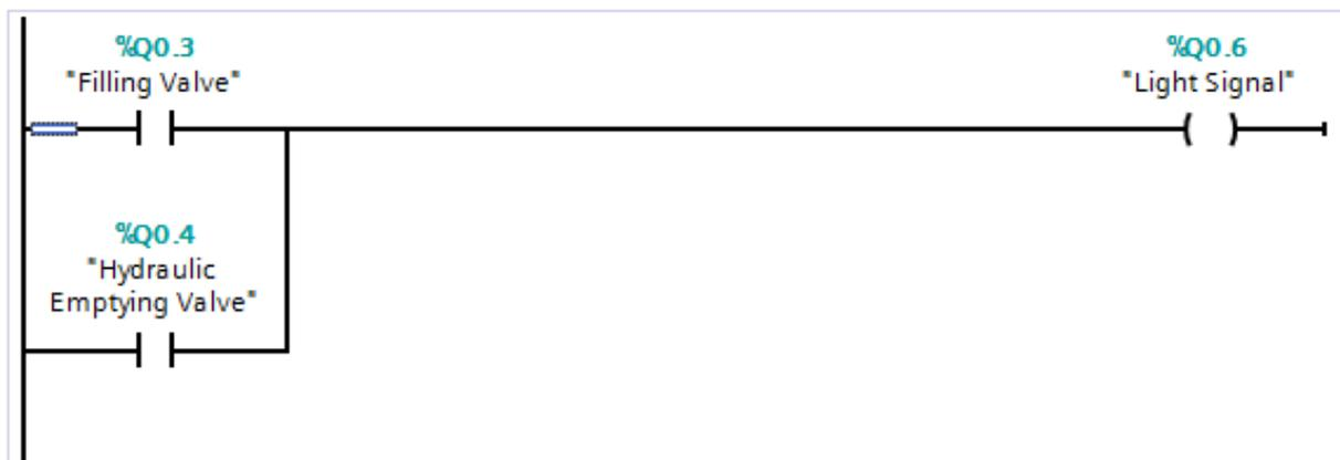
Figura 3.43: Programação Lógica da Função Sinal Luminoso de Alarme.
