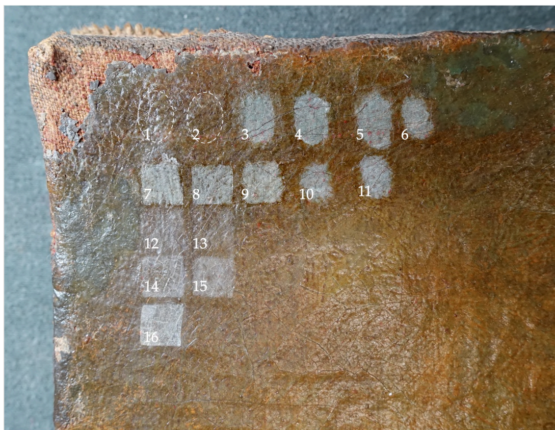
Figura 3.17: Resultados dos testes com solventes livres e géis. Legenda: 1) isooctano; 2) white spirit; 3) isopropanol; 4) etanol; 5) acetona; 6) isooctano e etanol na proporção de 50:50; 7) Nanorestore HWR com etanol a 50% durante 5 minutos; 8) Nanorestore MWR com etanol a 50% durante 5 minutos; 9) teste sem resultado; 10) isooctano e etanol na proporção de 90:10; 11) isooctano e etanol na proporção de 70:30; 12) Nanorestore HWR com etanol a 20% durante 5 minutos; 13) Nanorestore MWR com etanol a 20% durante 5 minutos; 14) PVA-Bórax com etanol a 20% durante 5 minutos; 15) PVA-Bórax com isopropanol a 20% durante 5 minutos; 16) PVA-Bórax com etanol a 20% durante 10 minutos.
