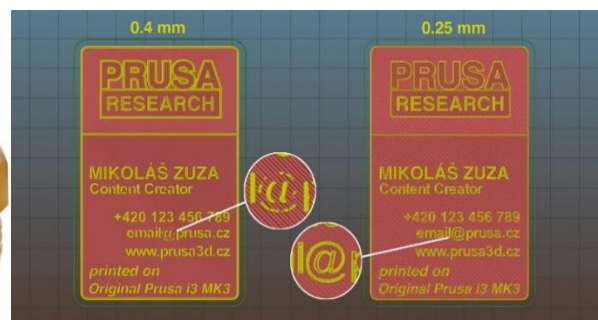
Figura 2.12 - Diferença na resolução entre bico de extrusão de 0.4 mm e 0.25mm. Adaptado de [28].
