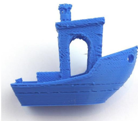
Figura 2.6 - Exemplo de peça impressa com falta de temperatura de extrusão. Adaptado de [23].
