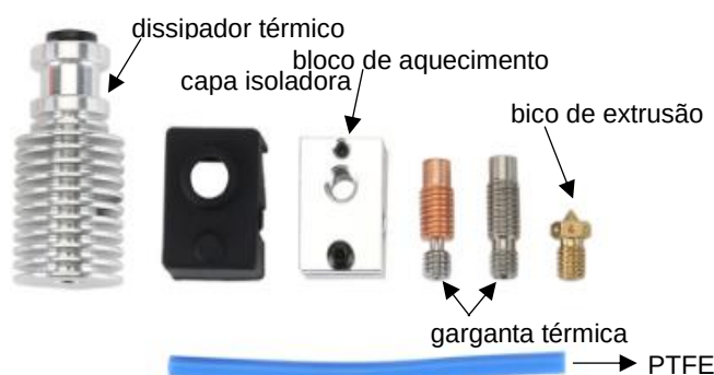
Figura 2.3 - Componentes da cabeça de extrusão.
