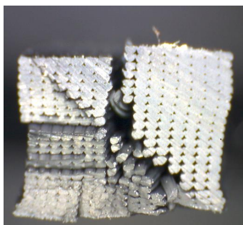
Figura 4.22 - Secção de fratura de um provete impresso com os níveis ideais dos parâmetros de impressão.
