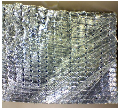
Figura 4.25 - Secção de fratura do provete concêntrico horizontal com multiplicador de extrusão de 115%.
